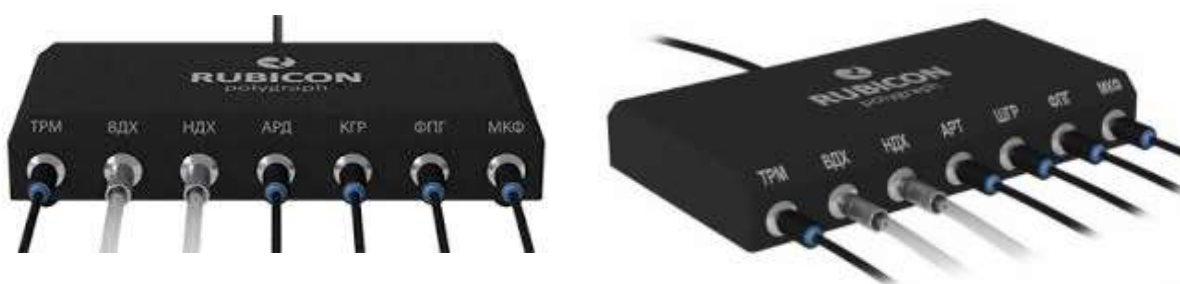
Рис. 2. Сенсорний блок комп'ютерного поліграфа Rubicon [268; 585]
