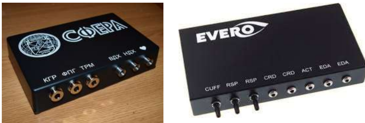
Рис. 6. Сенсорний блок комп'ютерних поліграфів «Сфера» та Evero [588; 586]
