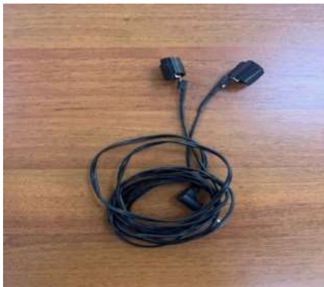
Рис. 1. Давачі для реєстрації електродермальної активності [568]
