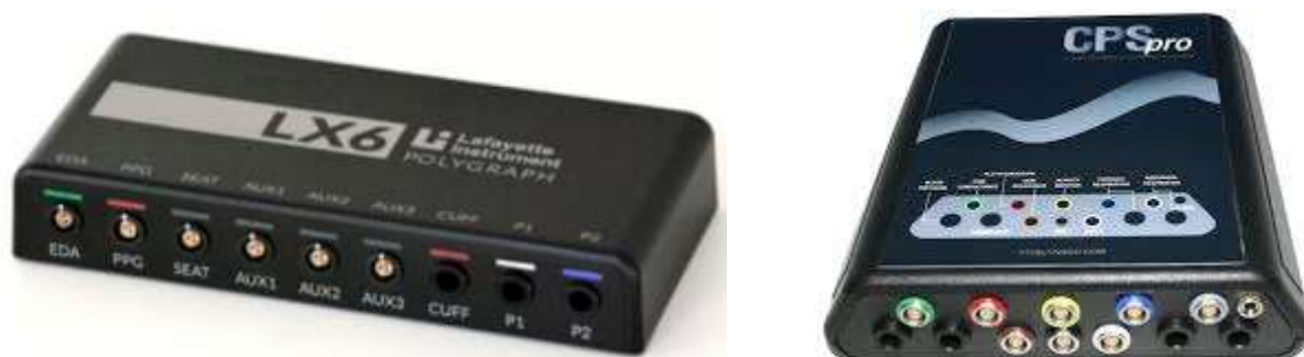
Рис. 4. Сенсорний блок комп'ютерних поліграфів Lafayette Instrument LXEdge та Stoelting CPS Pro [587; 334]
